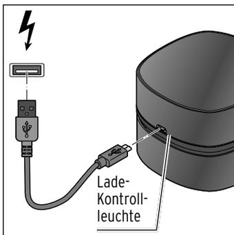
1. Schließen Sie den Mini-Tischstaubsauger wie abgebildet mit dem mitgelieferten Micro-USB-Ladekabel an einen USB-Netzadapter (nicht im Lieferumfang) an.
